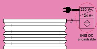
**M3** **Moteur HD** : livré avec récepteur RTS déporté et un transformateur 24/230 V de lg. 110 x ht. 53 x p. 30 mm.
