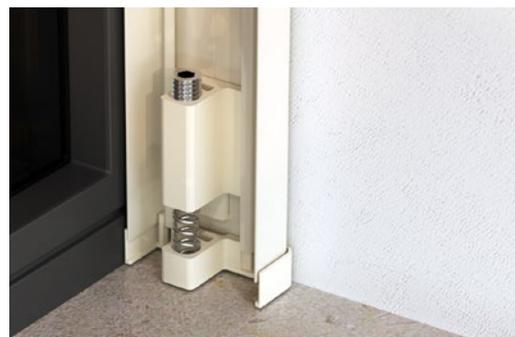
Ce dispositif, grâce à la combinaison de poussoirs et d'adhésif, permet d'absorber d'éventuelles irrégularités. Les compensateurs permettent de fixer la coulisse sur le dormant ou sur le bas du contre chassis. Compensation 10 mm sur la hauteur.
