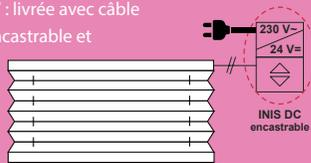
**M5 Moteur** livré avec récepteur RTS déporté et un transformateur 24/230 V de lg. 110 x ht. 53 x p. 30 mm.
