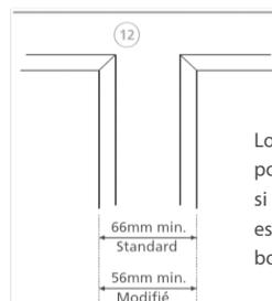
Lorsque deux fenêtres sont positionnées côte à côte, ou si le profil de recouvrement est particulièrement étroit, un boîtier raccourci est disponible.
