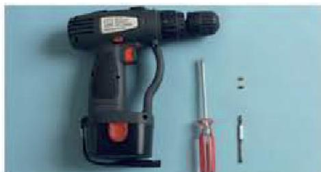
a1. Les outils de montage nécessaires sont un foret Ø4mm, un tournevis cruciforme
