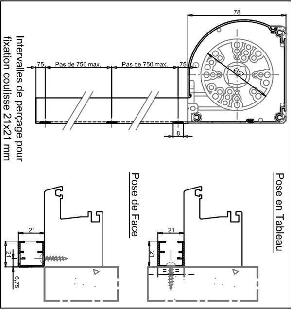
Intervalle de perçage pour fixation coulisse 21x21 mm
