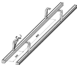
4. Appliquez les équerres de fixation sur la coulisse: le premier à 35cm, les suivants avec des écarts de 80cm, le dernier à 10 cm de la fin du store. Placez l'équerre sur le mur, marquez les emplacements de perçage et percez avec le foret adapté. Répétez l'opération pour l'autre coulisse.
