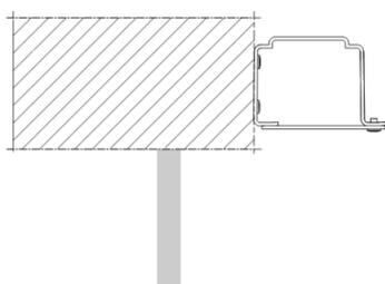
2. Placez le support sur le mur, marquez les emplacements de perçage et percez avec le foret adapté. Attention, l'axe doit être éloigné du mur ou de la menuiserie.
