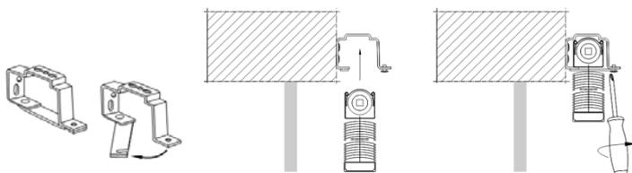
3. Ouvrez les supports, emboitez le profil supérieur dans tous les supports simultanément. Fermez les supports et serrez les boulons
