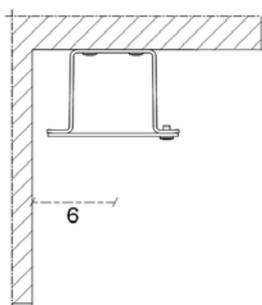
2. Placez le support sur le plafond, marquez les emplacements de perçage et percez avec le foret adapté. Attention, l'axe doit être éloigné du mur ou de la menuiserie au moins 6 cm.
