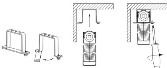
3. Ouvrez les supports, emboitez le profil supérieur dans tous les supports simultanément. Fermez de suite les supports et serrez les boulons.
