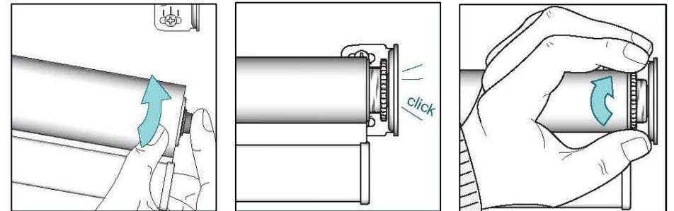
Verrouiller le store en tournant l'écrou dentelé contre le tube.
