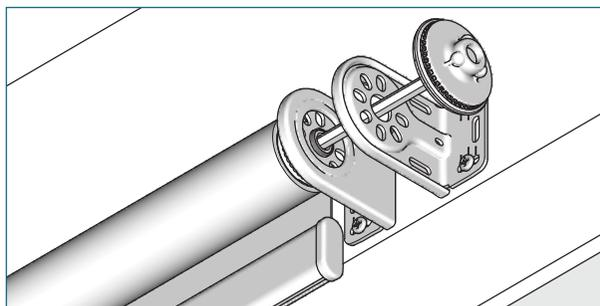
Pour les cas de couplage avec 2 supports intermédiaires! Fixez le support muni de son couvercle avec les vis fournies. Glissez le coupleur dans le palier, à travers le support.
