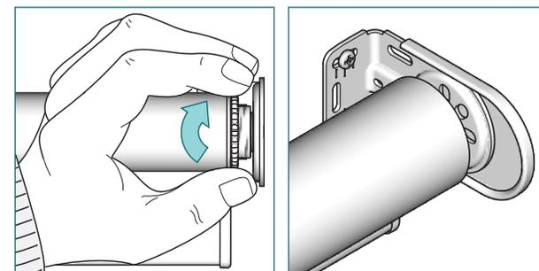
Bloquez cette position en tournant l'écrou dentelé du palier contre le support. Placez les couvercles des supports.
