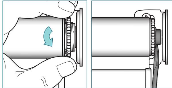
Desserrez l'écrou dentelé et glissez un tournevis entre le support et le palier et poussez vers le côté manœuvre.
