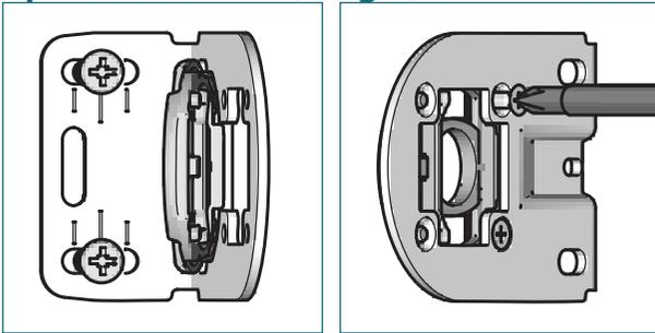
Assurez-vous que l'ouverture pour le passage de la clé Allen soit positionnée vers le bas avant d'installer les supports. Le cas échéant changer l'orientation du niveleur en retirant les deux vis (M3x6) et en retournant celui-ci de 90°.
