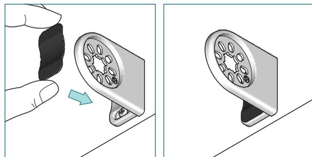
Le cas échéant, placez les cache vis sur les supports jusqu'à encliquetage.
