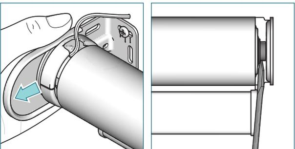
Débranchez le moteur. Retirez les couvercles des supports en les tirant vers vous. Glissez un tournevis entre le support et le palier et poussez le palier vers le côté de manœuvre.
