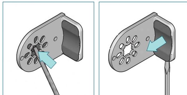
Dans le cas de supports décoratifs, retirez les capuchons en les pressant de l'intérieur et retirez les caches vis à l'aide d'un tournevis.
