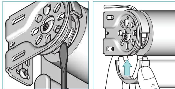
Branchez et réglez le moteur et les points de commande selon la notice spécifique fournie. Placez le couvercle sur le support du moteur.
