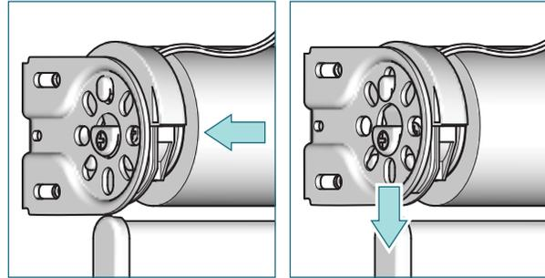
...Jusqu'à ce que le palier du moteur se positionne sur le support. Tirez vers le bas.
