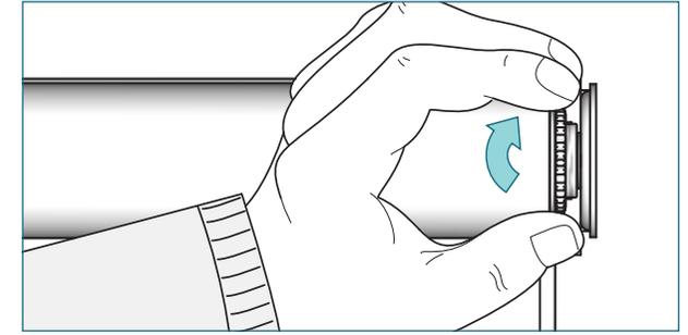
Bloquez cette position en tournant l'écrou dentelé du palier contre le support.
