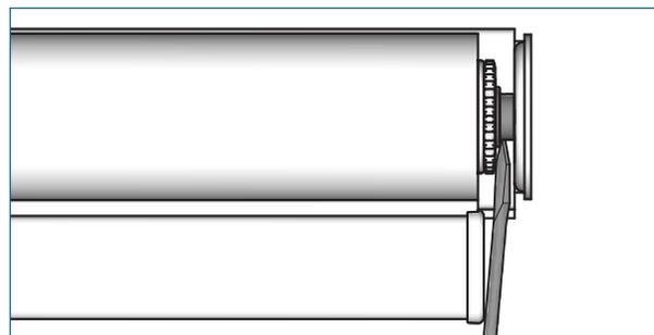
Déverrouillez le store en tournant l'écrou dentelé. Insérez un tournevis entre le support et le palier et poussez le palier vers le coupleur.
