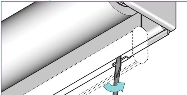
Placez un tournevis entre le support et le profil de montage et faites le pivoter de 45°.
