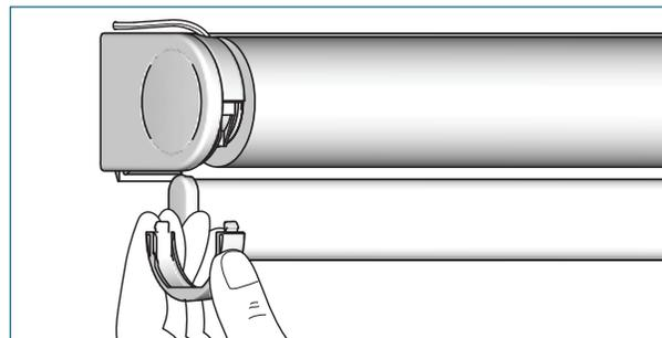
Retirez le couvercle du support de moteur. Branchez et réglez le moteur et les points de commande conformément à la notice de pose spécifique et fournie séparément. Remettez en place le couvercle du support de moteur.
