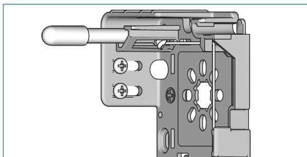
Enfilez les câbles par la partie avant et ouverte des supports.
