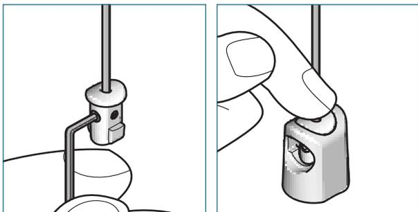
Glissez les câbles dans les inserts et fixez-les avec une clé Allen. Mettez l'insert dans le support et pressez-le vers le bas.
