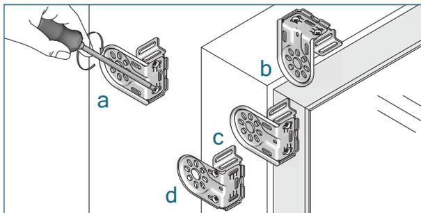
Fixez les supports de guidage au travers des supports de rouleau.
