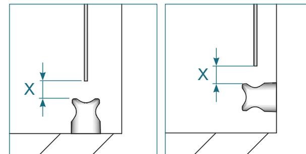
Fixez les supports à la verticale et dans l'axe des câbles. Raccourcir les câbles sans les tendre à une longueur telle qu'ils s'arrêtent à 5 mm des supports.
