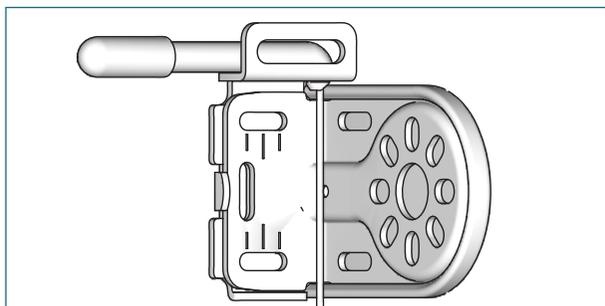
Passez les câbles au travers des supports de guidage par le trou oblong. La partie avant des tendeurs se positionne dans le trou.
