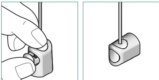
Glissez le couvercle de finition dans le support pour bloquer l'insert. Répétez l'opération avec le deuxième câble.
