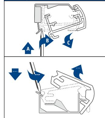
Attention à ne pas endommager le store en ouvrant l'emballage avec un cutter. Vis: Utiliser un tournevis taille 2 (POZIDRIVE) ou un tournevis électrique sur sa plus basse vitesse. Décrochage du store: Utiliser un tournevis plat de large maxi. Utiliser
