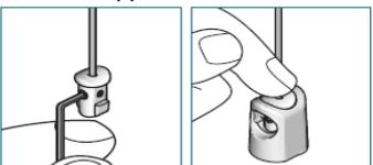
Glissez les câbles dans les inserts et fixez les avec une clé Allen. Mettez l'insert dans le support et pressez vers le bas.
