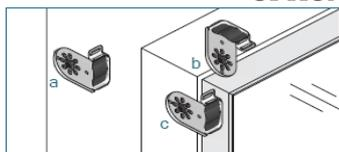
Fixez les supports de guidage au travers des supports de rouleaux
