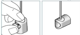
Glissez le couvercle de finition dans le support pour bloquer l'insert.
