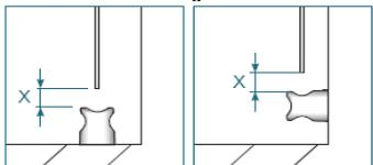
Fixez les supports à la verticale et dans l'axe des câbles. Raccourcissez les câbles sans les tendre à une longueur telle qu'ils s'arrêtent à 5 mm des supports
