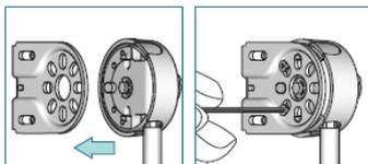
Positionnez le treuil manivelle sur le support et fixez le à l'aide des 2 vis fournies.
