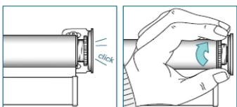
Encliquez le store sur le support. Fixez le store en tournant l'écrou dentelé contre le support. Glissez les couvercles sur les supports.
