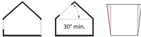
Ajustement possible jusqu'à 3 mm de chaque côté en **P1** pose vissée.
