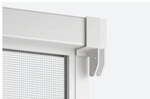
Hautement performant d'un point de vue technique et esthétique, les embouts télescopiques permettent de neutraliser les problèmes d'irrégularité des murs grâce à son mouvement horizontal et d'obtenir une finition parfaite. Ils compensent jusqu'à 8 mm par côté.
