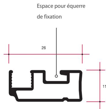
Encombrement 36 mm avec équerre de fixation.
