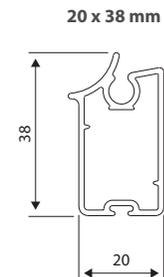
Avec insert anti-bruit (solution brevetée).
